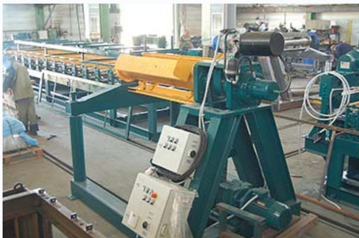
Размотчик может комплектоваться системой гидравлического разжима катушки крепления рулона. Устройство разжима рулона укомплектовано маслостанцией и пультом управления.
