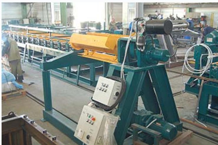
Разматыватель может комплектоваться системой гидравлического разжима катушки крепления рулона. Устройство разжима рулона укомплектовано маслостанцией и пультом управления.
